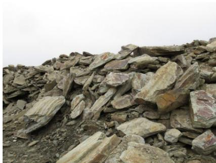
Para um muro com 1 m de altura e 70 cm de largura, deve prever-se cerca de 1 tonelada de pedra / metro linear de muro a construir.
