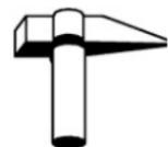
**Camartelo**, uma espécie de martelo, tendo de um lado cabeça ou pancada quadrada e do outro terminando em ponta. Serve para partir as pedras afeiçoando-as, e auxiliar o seu assentamento batendo-lhes levemente, com o cabo em movimentos verticais, torna-se uma ferramenta muito importante na trabalhabilidade do xisto.
