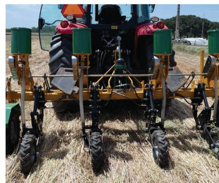
**FIGURA 1.** Protótipo de semeador monogrão equipado com discos GD da marca Weaving.
